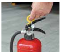
①ピンを抜く 黄色いピンを抜く
