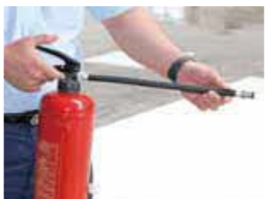
②構える ノズルを火元に向ける
