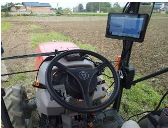
自動操舵システムを取り付けた トラクター
