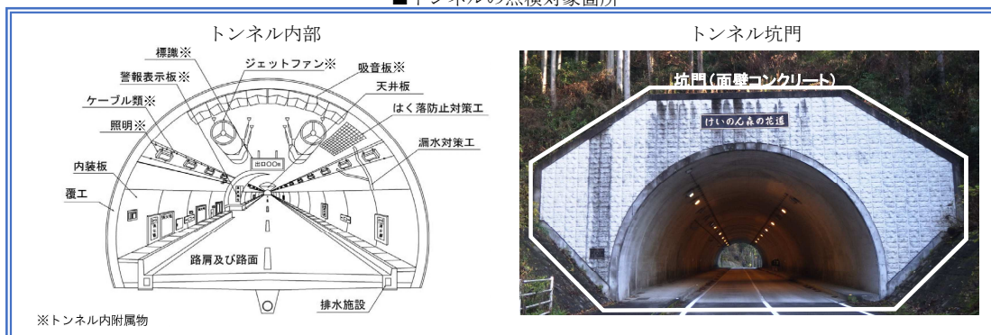
■トンネルの点検対象箇所
