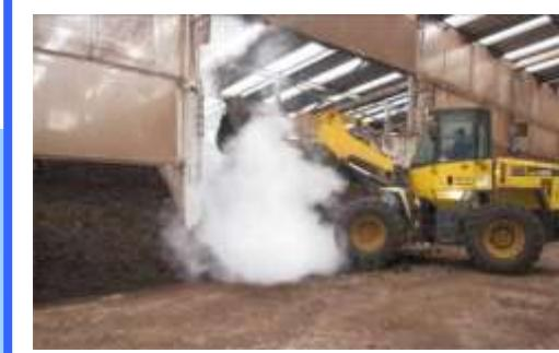
大きなホイルローダーで脱水汚泥と種菌を混ぜ合わせます。
