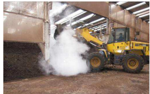
大きなホイールローダーで脱水汚泥と種菌を混ぜ合わせます。
