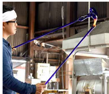
ガラス竿の2本使い “二刀流”と呼ばれている (副島硝子工業株式会社)
