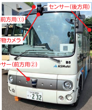
▲自動ハンドル・ブレーキ操作 (センサーで位置情報を確認)
