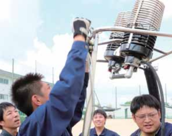
▲立ち上げ作業の1コマ。バスケットにバーナーを取りつける。
