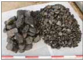
▲石炭 化学分析の結果、蒸気船の燃料にも適した良質の石炭であることがわかりました。
