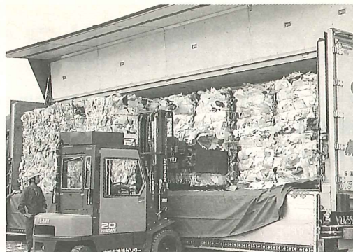
圧縮したプラスチック系ごみの積み込み作業
