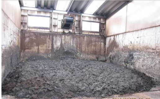
原料となる脱水汚泥。まだかなりねばねばしています。
