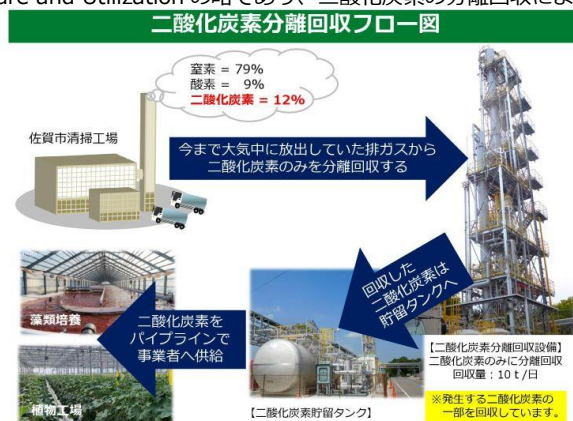
二酸化炭素分離回収フロー
