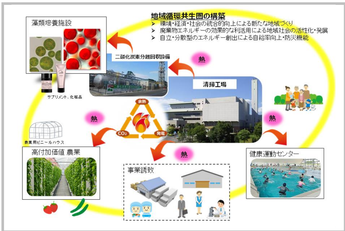
◆図表 3-39 佐賀市における「地域エネルギーセンター」としての清掃工場と周辺施設のイメージ（熱利用）
