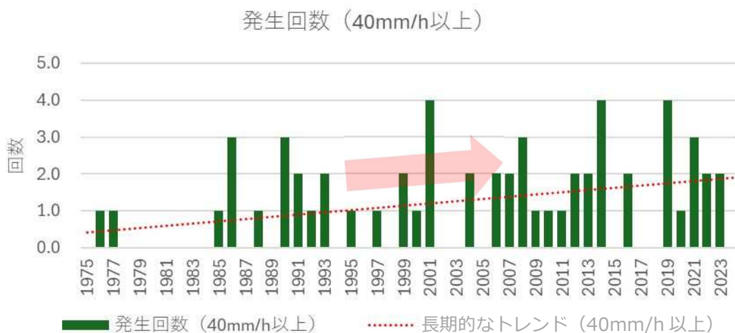
図 2.4.9 時間40mm以上の降雨の年間発生回数とトレンド：佐賀（気象庁）
