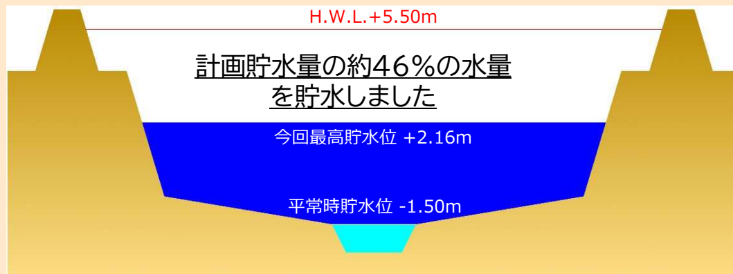
巨勢川調整池の断面図
