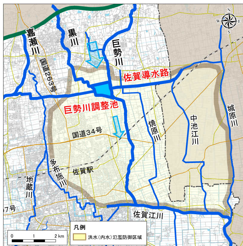
図 3.4.4 巨勢川調整池の洪水（内水）防御区域
