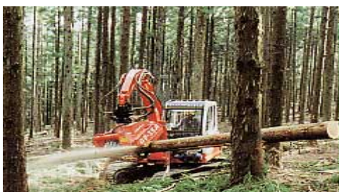
高性能林業機械（プロセッサ）
