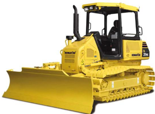
ブルドーザー: 土の押土に使用
