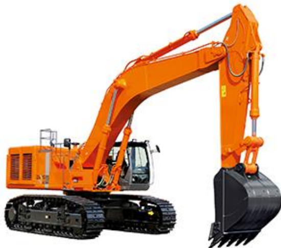
バックホウ: 土の掘削に使用
